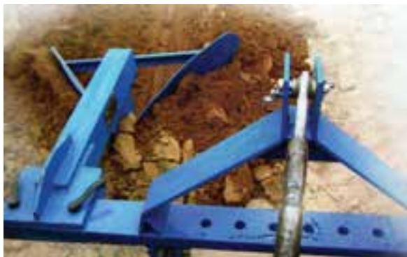
شکل ۴۸-۱- نهرکن کنشی در حین حفر نهر
