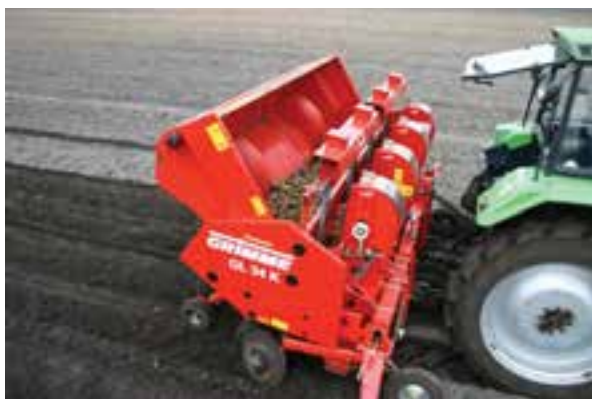
شکل ۱۷-۲- طرز کار یک نوع سیبزمینی کار خودکار
