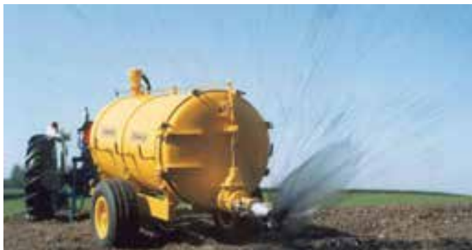
شکل ۱-۳۷- یک نوع کودپاش کود دامی مایع
