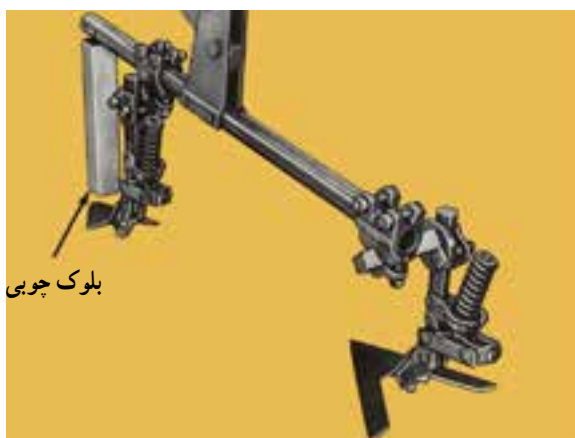
شکل ۱۲-۳- استفاده از قطعه چوب برای تراز پنجه
