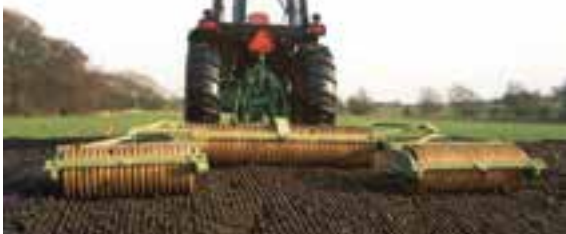
شکل ۳۴-۱- نحوه اتصال چند گروه غلتک حلقوی
