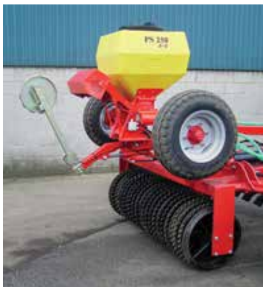
ب- غلطک کمبریج بر روی ماشین مرکب
