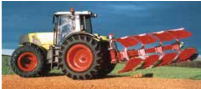
شکل ۳-۱- گاو آهن برگردان دار دو طرفه
