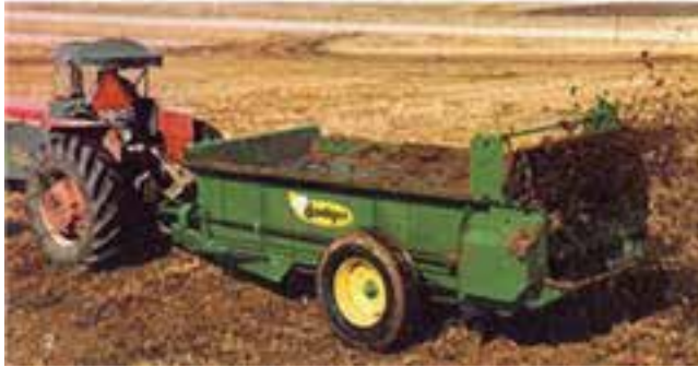
شکل ۳۸-۱- کودپاش کود دامی جامد در حین کار
