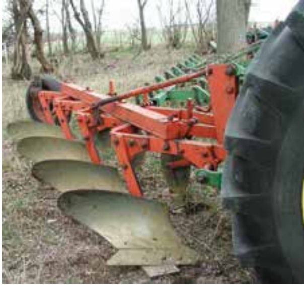
شکل ۲-۱- گاو آهن برگردان دار یک طرفه
