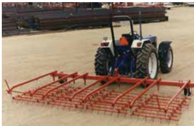
شکل ۱-۳۰- اتصال چند قاب به مالبند
