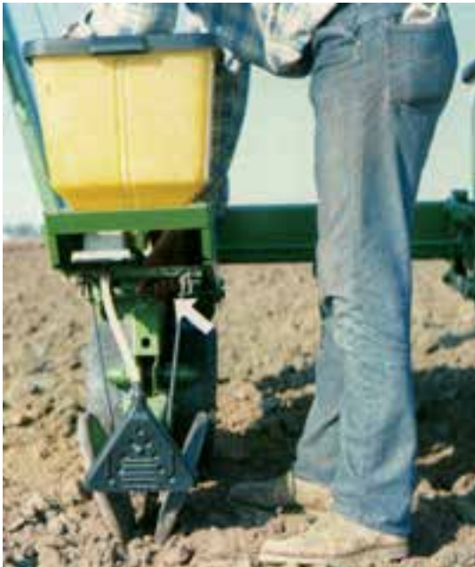
شکل ۲-۱۰ – چرخ تنظیم عمق برای کنترل و کم و زیاد کردن عمق کاشت
