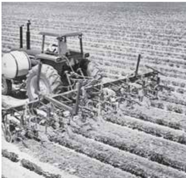
شکل ۲۶-۳- سم‌پاشی همراه با وجین
