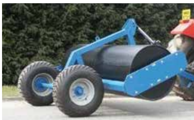
شکل ۱-۳۶- غلطک رویه صاف
