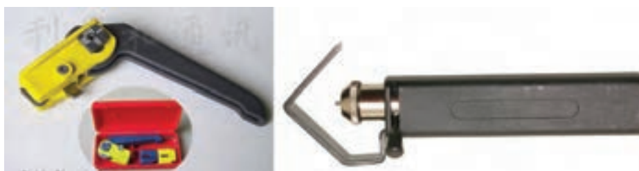
شکل ۳-۳۳- روکش بردار کابل
