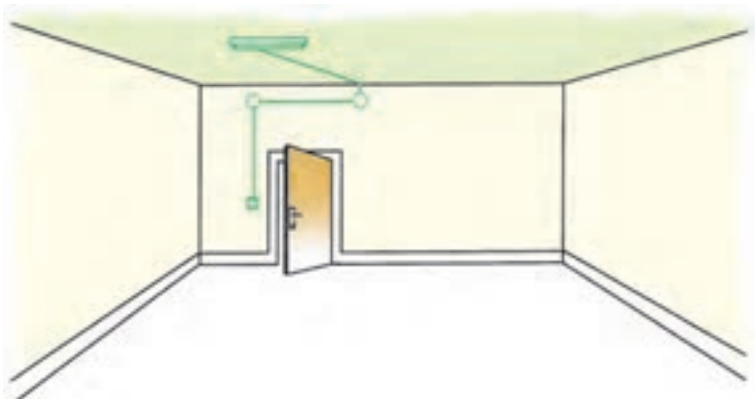
شکل ۳-۶۵- مدار الکتریکی کلید یک پل
