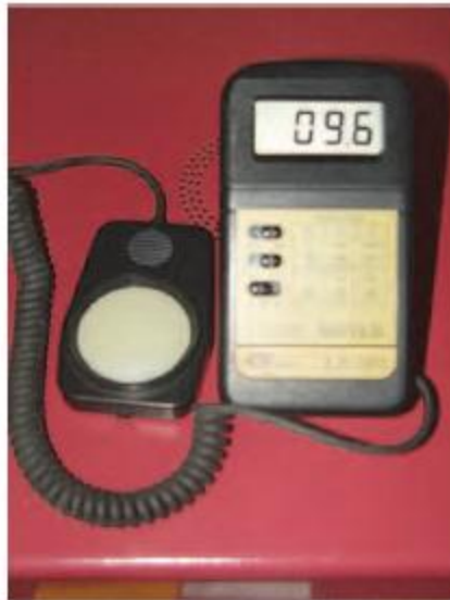
شکل ۳- لوکس متر برای کنترل شدت نور در سالن های مرغداری
