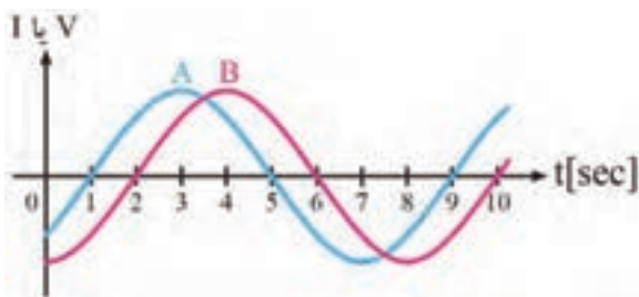
شکل ۱-۶۲ اختلاف فاز یک ثانیه
